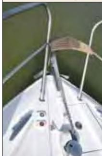
Guarda-mancebo bom, alto e bonito. Cunhos (seis) apropriados e com asas arredondadas. Todo o material em aço inox 316 l. Apesar de ter trava para âncora, não há um cunho específico para ela. A escada de popa é uma das melhores entre as lanchas deste porte.
