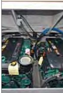
Há apenas uma opção de motorização mas ela é bem adequada: um par de Volvo D4, de 300 hp, diesel, com hélices modelo G6. A relação de transmissão das rebetas é de 1,76:1. Espaçosa, a casa de máquinas permite fácil acesso para manutenção.
