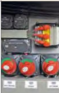
Segue o padrão das demais instalações do barco. São cinco baterias, incluindo serviço, dois motores, bow thruster e gerador, este de 6.1 Kw. O quadro elétrico é de fácil acesso e as chaves de bateria são eletromagnéticas, fáceis de achar e devidamente codificadas. Tudo longe da água.
