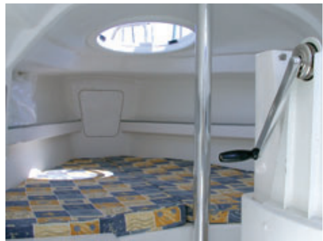
Cabine O içamento da quilha — feito através de engrenagem acionada por manivela — é funcional
