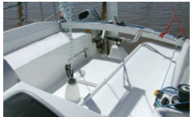
Cockpit O trilho do traveller — acessório opcional — é fixado na aresta superior do espelho da popa
