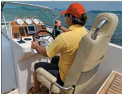
O posto de comando é muito confortável para pilotar sentado ou em pé. O banco tem muitas regulagens, para frente e para trás, de altura e é giratório. Porém, falta apoio para os pés. No painel, há grandes relógios para os motores e espaço para um gps de até 5 polegadas.
