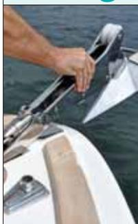
Todas as ferragens são de aço inox importado e, segundo o estaleiro, exclusivas no mercado. O lançador de âncora fica embutido, para não prejudicar o design do barco, e tem um engenhoso mecanismo de lançamento. Em vez de guarda-mancebo, há dois corrimões na parte central do capô.
