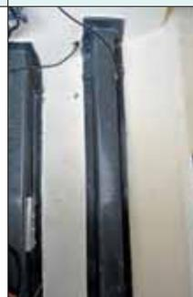
O casco é muito forte, com laminação sólida e tecidos multiaxiais. No convés, para maior leveza, é usado sanduíche de fibra com espuma de pvc rígida, o que deixa o centro de gravidade mais baixo. As longarinas da popa têm reforço de fibra de carbono, para suportar motores mais potentes.
