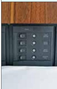
Vem de série com fios estanhados e codificados, tomada para cais e duas baterias de 110 Ah, sendo uma exclusiva para o motor e a outra para serviços. Para maior proteção contra as intempéries, o painel de disjuntores fica na cabine, em local de fácil acesso.
