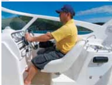
A visibilidade é boa para todos os bordos, embora a moldura do pára-brisa atrapalhe um pouco. O banco do piloto é giratório, mas não tem regulagem, o que é ruim na hora de comandar em pé (a perna fica raspando no volante). No painel falta espaço para a sonda e GPS (que precisam ficar em um suporte saliente).
