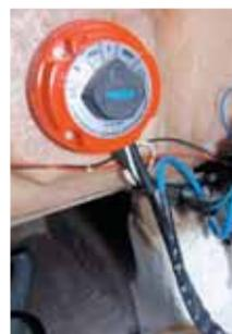
Vem de fábrica com chicote elétrico de fios estanhados, mas não codificados, como seria ideal. Na lancha testada, que era apenas um protótipo, a bateria não estava bem fixada, o que, em tese, representa um risco de incêndio. Pode ter instalação para som e DVD com tela de até 8 polegadas.
