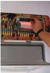
As fiações não são codificadas, mas o estaleiro promete mudar isso nas próximas lanchas. A instalação elétrica foi dimensionada para alimentar vários equipamentos elétricos, como TV, microondas e ar-condicionado. O quadro de fusíveis fica na cabine e é bem acessível para manutenção.
