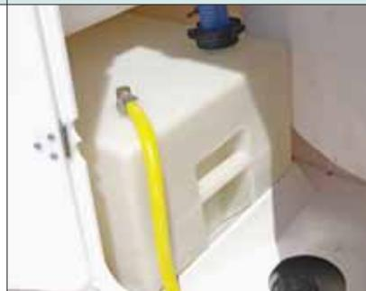
O tanque de combustível, de 96 litros, permite navegar mais de 100 milhas sem abastecer. E o tanque de água, de 50 litros, é suficiente para um dia inteiro de pescaria. Ambos os tanques ficam dentro do console e têm fácil acesso para inspeção e manutenção.
