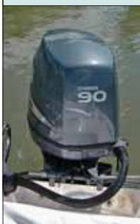
O estaleiro indica um de popa, de 60 a 115 hp. Porém, 60 hp pode ser pouco. Neste teste, um motor de quatro tempos Yamaha de 90 hp foi suficiente para levar a lancha a 33 nós. Já um de dois tempos e injeção direta rendeu quase dois nós a mais.
