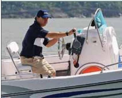
O banco do piloto não permite regulagem de distância nem de altura. Contudo, na hora da encomenda da lancha, o estaleiro pode instalá-lo na medida desejada pelo piloto. No barco testado, estava com boa altura. Porém, o assento é bem estreito e, por isso, desconfortável.
