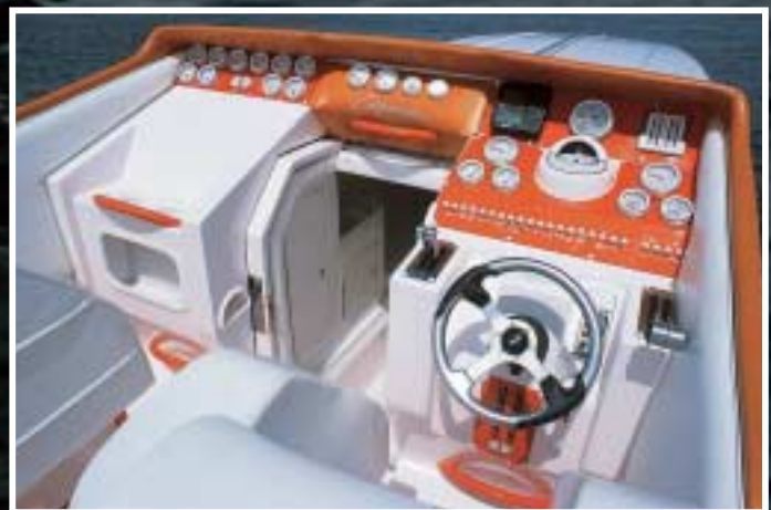
Painel Para acomodar a vasta instrumentação dos motores, os relógios se espalham pelos dois bordos
