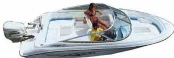
**MOTORIZAÇÃO UTILIZADA:** 1 motor de popa Evinrude 90 Ficht FPL, 90 hp, V4, 1.726 cm<sup>3</sup>, com relação de transmissão de 2:1 e hélice de alumínio (3 pás) de 14" x 17".
