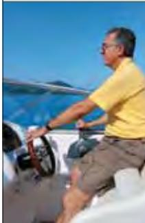
O banco retrátil favorece a pilotagem e permite boa pega no manete. O suporte dos pés tem ângulo adequado. A moldura superior do para-brisa atrapalha um pouco a visão de quem pilota sentado e o VHF, sob o painel, pode incomodar o joelho.
