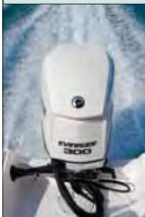
O novo E-TEC de 300 hp impressionou pelo baixo ruído e pouca vibração. No desempenho, levou 7,3 segundos para ir da marcha lenta aos 20 nós, um pouco abaixo do esperado, por conta do peso um pouco maior do casco.
