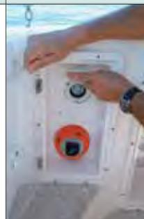
O barco testado tinha tomada de energia de cais com disjuntores. O inversor, opcional, deve ser usado com cuidado para não descarregar a bateria. Os chicotes têm boa fixação. Há caixa para bateria e vários pontos de luz de cortesia.
