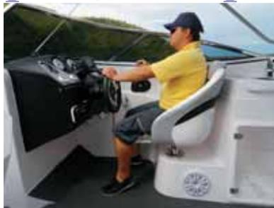
O banco do piloto é giratório, tem assento rebatível e permite boa visibilidade, exceto durante o início do planeio. Seu peçado é ser baixo, mesmo quando dobrado, deixando a pilotagem desconfortável em águas mais agitadas, quando o condutor geralmente fica em pé.
