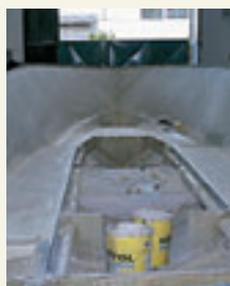
É bem laminada e reforçada, com duas longarinas de proa a popa, ambas preenchidas com espuma. Aliás, todos os demais espaços ocultos do casco são recheados com espuma de poliuretano, o que torna a lancha insubmersível, segundo o estaleiro.
