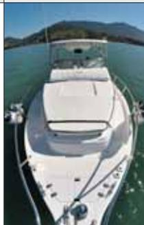
É de boa qualidade, com o uso de espuma de pvc rígida no casco e reforços, como duas longarinas e algumas cavernas. No caso de acidente, a flutuabilidade, segundo o estaleiro, é garantida com o preenchimento de espuma de poliuretano.
