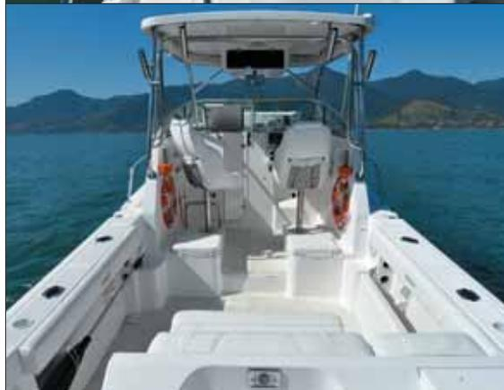
de direção e instrumentos. Mas ele fica um tanto alto demais (1,15 m em relação ao piso), por causa da altura privilegiada da cabine, podendo, assim, prejudicar a visibilidade. Até porque, neste teste, a 260 WA também mostrou uma tendência a erguer a proa nas arrancadas, o que precisa ser compensado com o uso de flapes.
