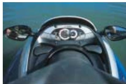
O painel LCD multifunção e espelhos automobilísticos são itens de fábrica
