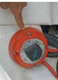
Baterias, chave geral, quadro de disjuntores e até as luzes de navegação não fazem parte dos equipamentos instalados pela fábrica, mas há lugar de sobra para tudo isso. No barco testado, a chave geral estava dentro do paiol de popa, a salvo da água.
