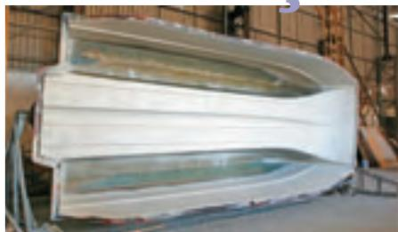
O casco é de fibra, mas, para diminuir o peso, mantendo a resistência, no costado foi usada uma estrutura sanduíche. O núcleo desse sanduíche é preparado durante a laminação, baseado numa massa à base de poliéster, com fibra e microesferas de vidro.
