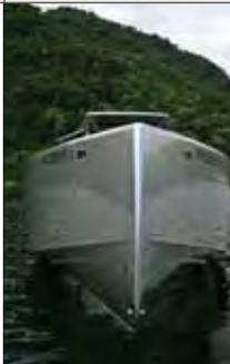
Usa kevlar nas cavernas e fibra de carbono (material também muito resistente) na capota, no banco de pilotagem, nas longarinas, no lançador de âncora e alguns pegadores. Casco e convés são laminados a vácuo.
