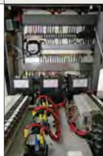
A fiação é estanhada, com certificação internacional. As chaves gerais estão bem localizadas, na parte traseira do cockpit, e o quadro elétrico, na cabine, com fácil acesso. As baterias são da marca Optima, de alto desempenho.
