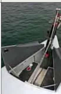
Destaque para um grande existente na frente da cabine, com acesso por uma gaiuta no convés. Pode ser usado para guardar defensas, cabos, âncora de reserva e material de limpeza ou até mesmo como cabine para marinheiro.
